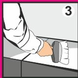
**3** Перед укладкой первого ряда блоков обеспыльте основание и обработайте его грунтовочными составами БОЛАРС, соответствующими Вашему типу поверхности.
