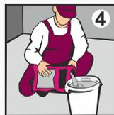
**4** Для подготовки смеси возьмите чистую водопроводную воду комнатной температуры из расчета 4,0-5,0 л воды на 1 мешок (25 кг) и залейте её в чистую ёмкость. Для затворения смеси используйте воду, подогретую до температуры 20-30°C.
