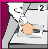
**2** Выровняйте основание. Впадины, трещины и неровности до 15 мм выровняйте клеем БОЛАРС «Монтажный», свыше 15 мм – штукатурными составами БОЛАРС.
